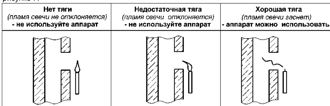
Рисунок 7. Способ проверки тяги в дымоходе
