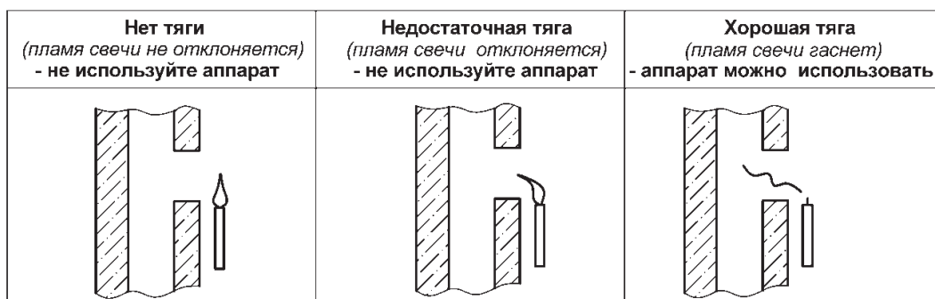
Рис. 4. Способ проверки тяги в дымоходе
