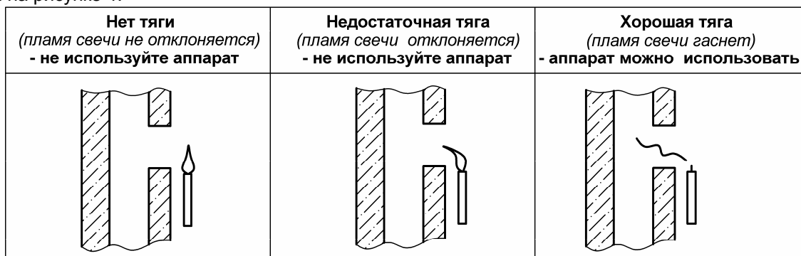
Рисунок 4. Способ проверки тяги в дымоходе
