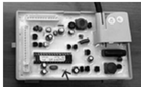
**Рисунок 9. Место установки переключки в регуляторе розжига**
