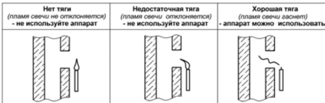
Рисунок 4. Способ проверки тяги в дымоходе
